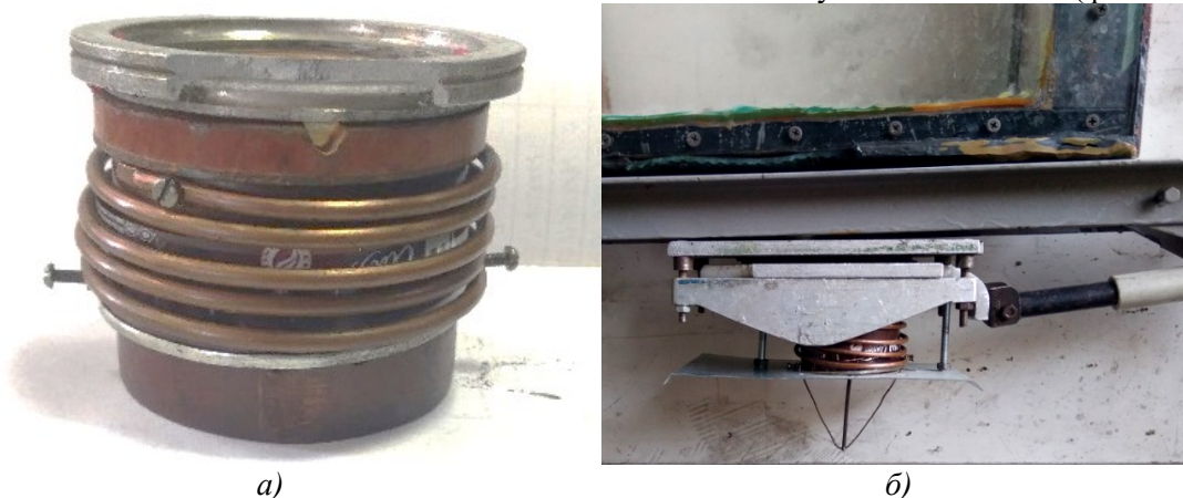
Рис. 5. Конструктивное исполнение силового узла катапульты (а) и относительное положение ее элементов во взведенном (б) состоянии после установки на модель
